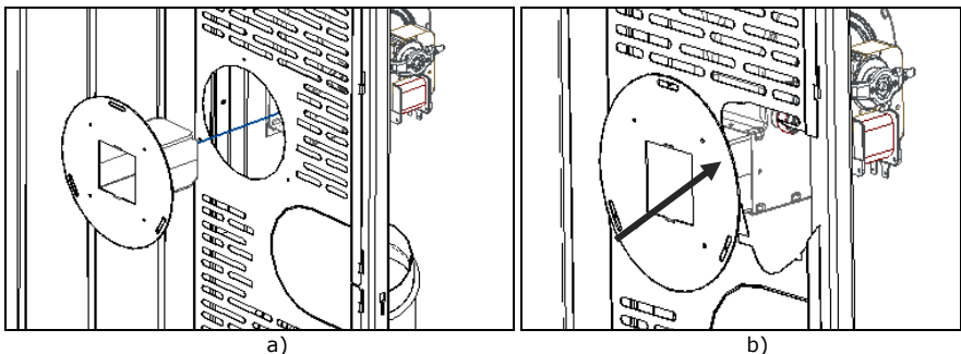
Figura 60 - Encaixe guia de ar na salamandra
